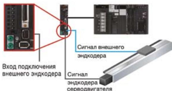
Рис. 6. Применение сервосистемы Accurax G5 на приводе подачи
