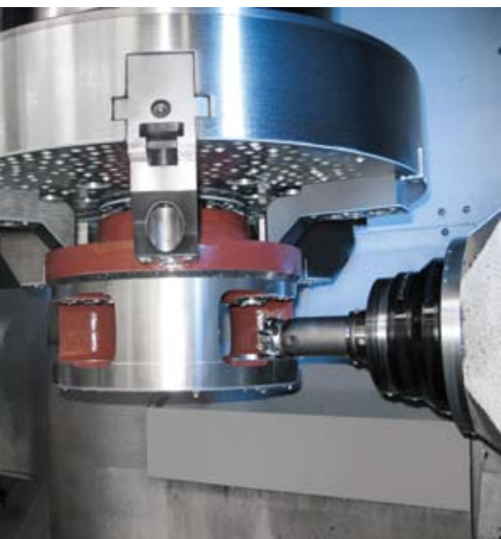
VLC 500 MT: Операции сверления, фрезерования, точения осуществляются на одном станке. Комплексная обработка деталей для привода ориентации ветрогенераторной установки
