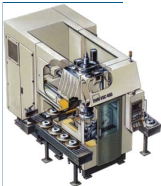
Вертикальные токарные производственные центры «Pick-Up»-компоновки компании EMAG: шпиндель сам захватывает заготовку, в результате обработка, загрузка и выгрузка, а также измерение производятся автоматически, на одной единице оборудования.
