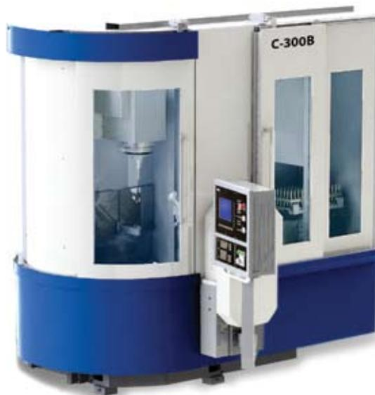
Рис. 1. Многокоординатный шлифовально-заточной станок с ЧПУ
