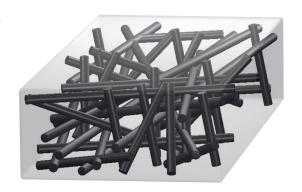
Однонаправленные **F-модуль** перпендикулярно аправлению волокон 13000 H/mm<sup>2</sup> Е-модуль параллельно направлению волокон 50000 H/мм<sup>2</sup>
