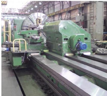
Станок модели 1А670 – тяжелый токарный двухсуппортный станок для обработки деталей из чугуна, стали и других сплавов. Макс. наружный диаметр обрабатываемого изделия, ограничиваемый станиной – 2 000 мм. Макс. длина обработки над суппортом – 14 000 мм.
