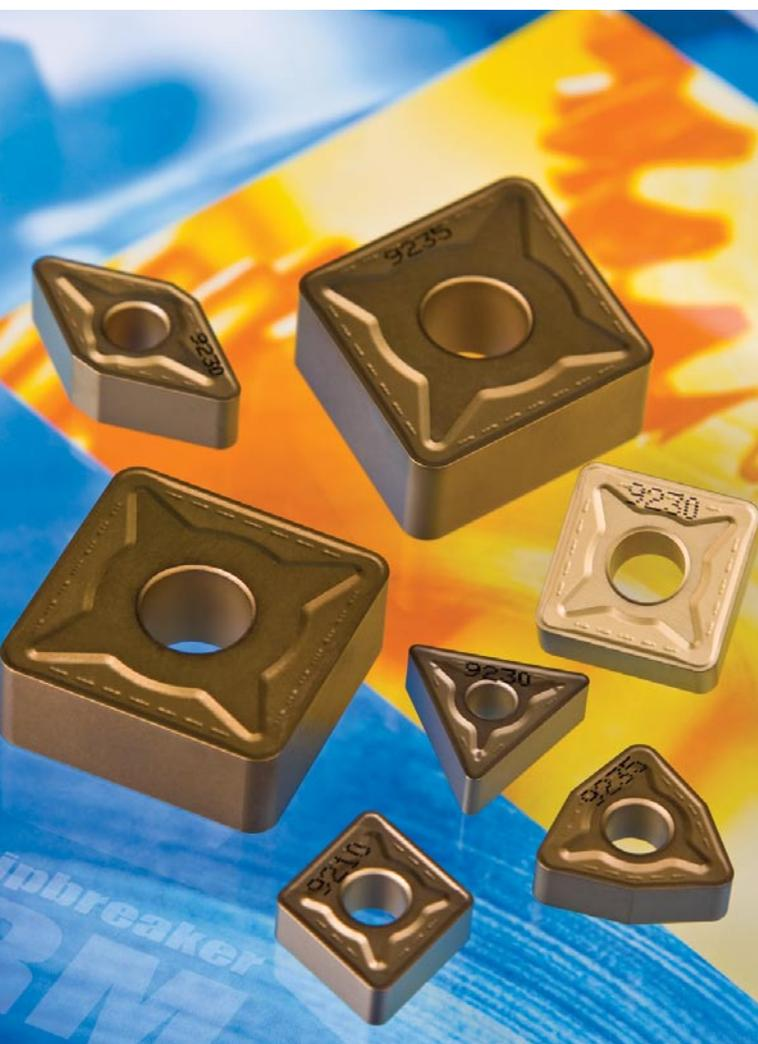
рынка и обеспечивает процесс стружколома в широком диапазоне подач и глубин резания. Разрабатывалась она специально для полустового и черногого точения материалов групп P, M и K. Также можно при определённых условиях работать ей при точении материалов групп S и H. Пластины с этой геометрией возможно применять как для непрерывного резания, так и для обработки с ударом.
